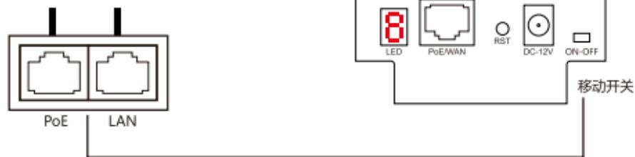
POE电源的POE网口通过网线连接到室外CPE的WAN口，将电源插入插座，即可通过网线给CPE供电。注意POE电源需要和CPE支持的电压电流匹配，这里支持24V0.5A/1A（型号：CPE300），或48V0.45A/0.6A（型号：CPE300P）
